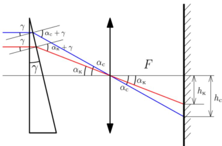
Обозначим как  $\alpha_c$  и  $\alpha_{кр}$  углы, которые будут составлять синий и красный лучи с оптической осью линзы после прохождения призмы. Тогда можно записать законы преломления для таких лучей:
