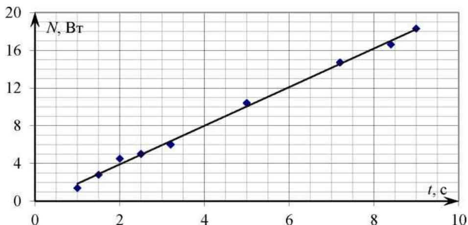
В момент времени  $\tau = 6$  с мощность должна составлять 12 Вт. По угловому коэффициенту наклона графика  $k = F^2/m = 2$  Вт/с определяем значение силы  $F = \sqrt{km} = 2$  Н.
